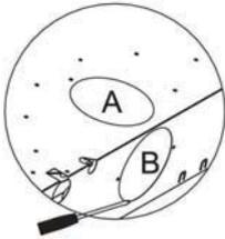
Für den direkten Anschluss an eine Abluftmöglichkeit an der Rückseite der Haube, entfernen (hebeln) Sie die Abdeckung B vorsichtig mit einem flachen Schraubenzieher.
