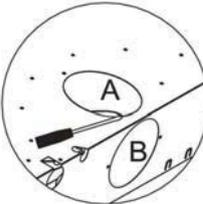
Für den Anschluss des Abluftschlauches nach oben entfernen (hebeln) Sie Abdeckung A vorsichtig mit einem flachen Schraubenzieher
