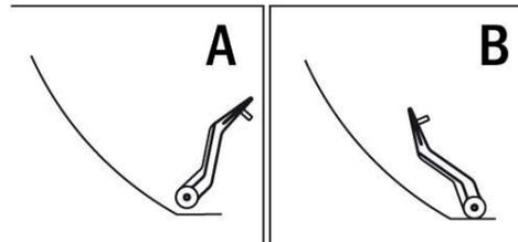
Um die Betriebsart (Ab- oder Umluft) einzustellen, entfernen Sie die Fettfilter. Mit dem unter den Filtern befindlichen Schalter (siehe Abb.) wählen Sie dann den Modus.
